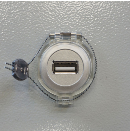
图 29 使用封锁线锁死 USB 端口
